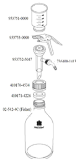
Fig. B.1.2-1 Partes del dispositivo de filtración
